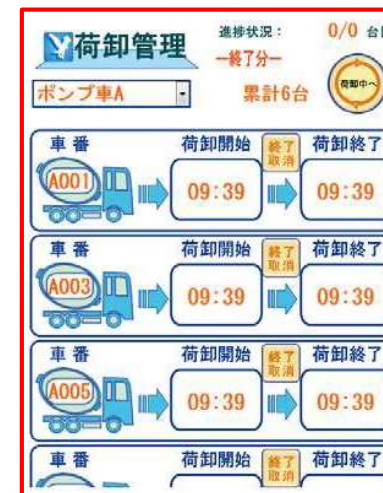
ポンプ車荷卸開始/終了時刻入力画面(終了分)
