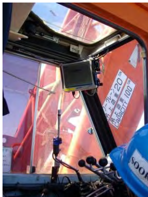
モニターを見ながら操作
